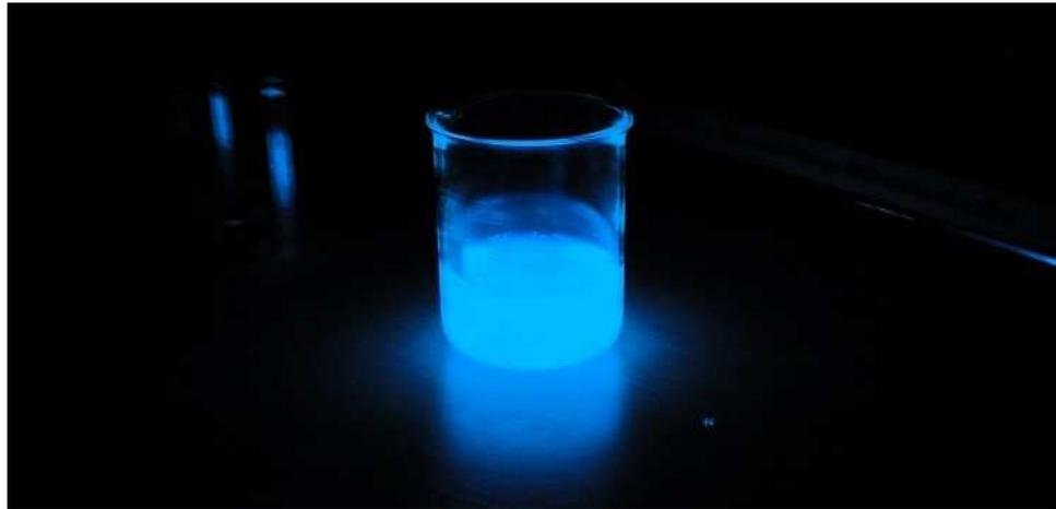
Abbildung 2: Lumineszenz von Luminol um Dunkeln
