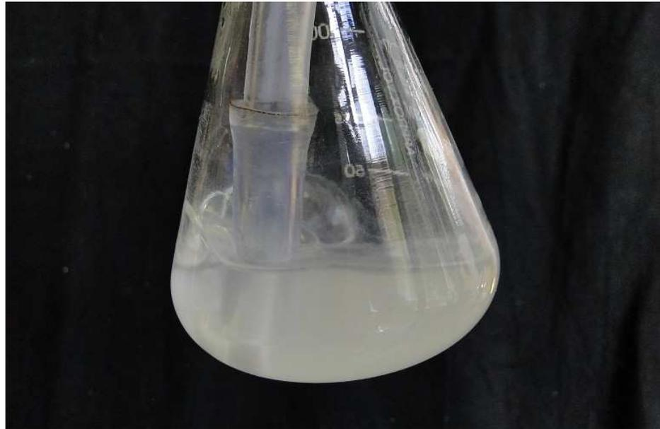
**Deutung:** Bei der Verbrennung von Holzkohle entsteht Asche und Kohlenstoffdioxid, was an der Trübung des Kalkwassers zu beobachten ist. Die Stoffumwandlung lässt sich wie folgt formulieren:
