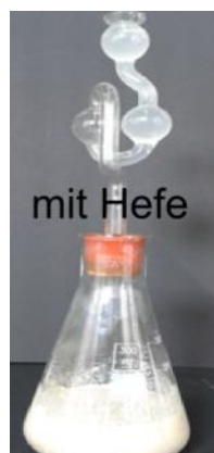
Abb. 11 – Kohlendioxidnachweis mit Kalkwasser beim Ansatz mit Hefe
