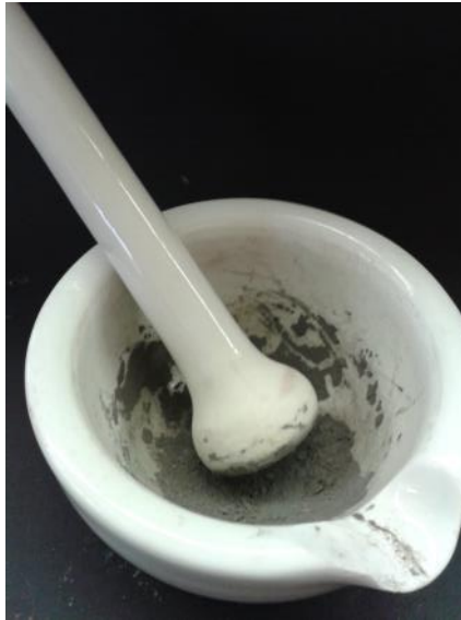
Abb. 4 – Exotherme Reaktion von Kupfer- und Schwefelpulver nach Überwindung der Aktivierungsenergie durch Mörsern
