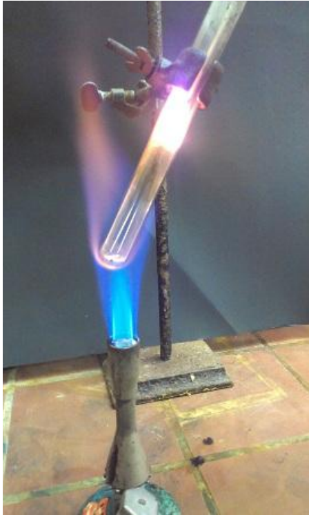
Abb. 4 - Glimmspanprobe während des Erhitzens
