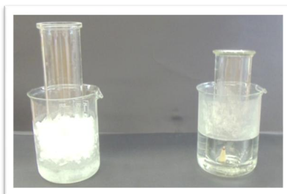
Abbildung 1: Der Versuchsaufbau für den Versuch „Inversionswetterlage“. Links der Standzylinder im Eisbad und rechts im Wärmebad.
