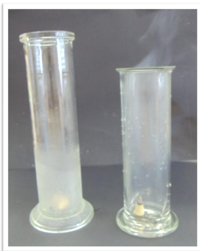
Abbildung 2: Die Inversionswetterlage links. Der Rauch sammelt sich im unteren Bereich des Standzylinders. Die normale Wetterlage rechts. Der Rauch entweicht.
