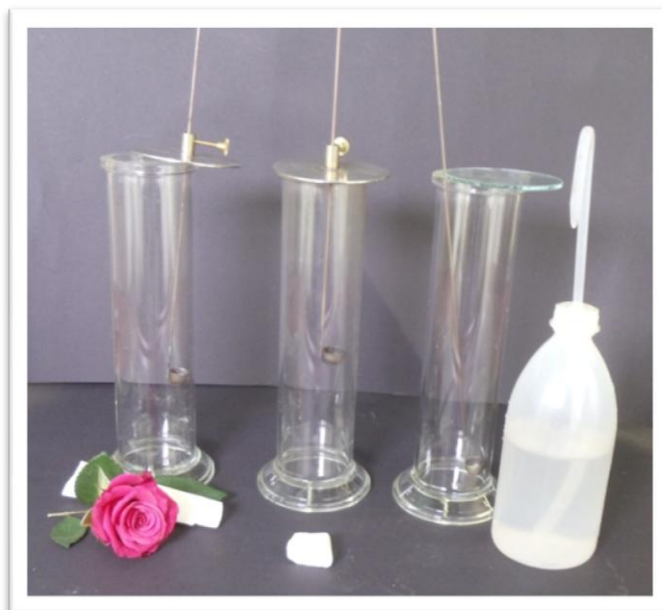
Abbildung 1: Versuchsaufbau für den Versuch „Schwefeldioxid in der Umwelt“.
