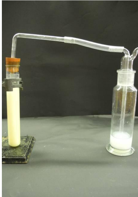
Abb. 6 - Trübung der Kalkwasserlösung in der Waschflasche.
