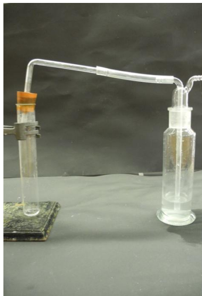
Abb. 5 - Versuchsaufbau „Kohlenstoffdioxid-Nachweis bei Brausetabletten“.
