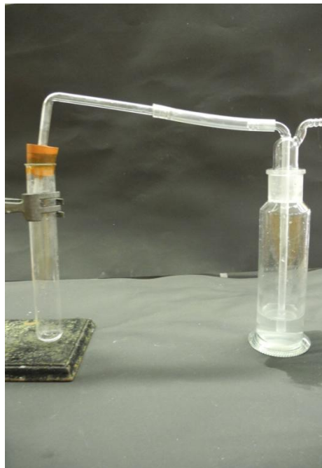
Abb. 8 - Versuchsaufbau „Kohlenstoffdioxid-Nachweis in Mineralwasser“.
