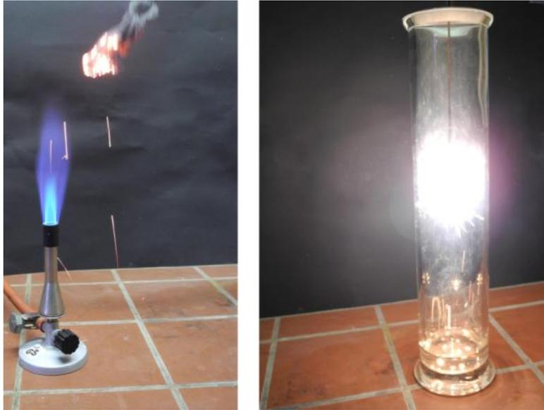
Abbildung 1: glühende Eisenwolle in der Brennerflamme (links), Reaktion der Eisenwolle im Standzylinder mit Sauerstoff (rechts).
