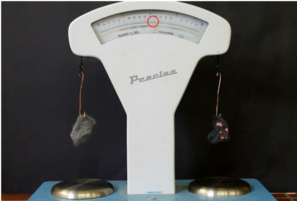
Abbildung 1: Balkenwaage mit Eisenwolle (links) und glühender Eisenwolle (rechts).
