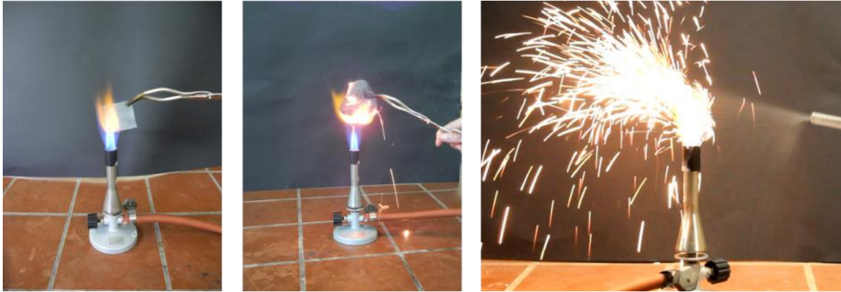
Abbildung 3: Eisenblech in der Brennerflamme (links), Eisenwolle in der Brennerflamme (mitte), Eisenpulver in der Brennerflamme (rechts).
