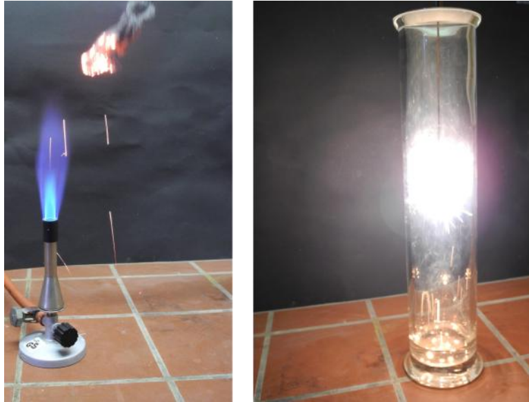
Abbildung 2: glühende Eisenwolle in der Brennerflamme (links), Reaktion der Eisenwolle im Standzylinder mit Sauerstoff (rechts).
