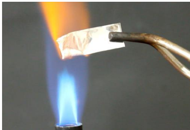
Abbildung 4: Aluminiumblech in der Brennerflamme.
