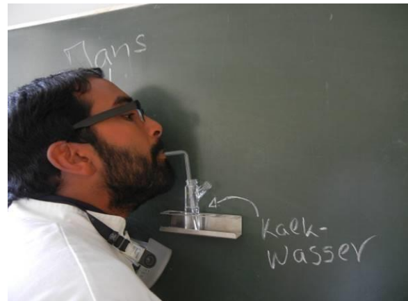
Abb. 5 Versuchsaufbau zum Nachweis von Kohlenstoffdioxid der Atemluft
