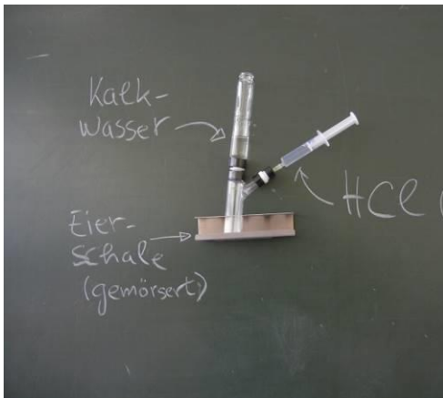
Abb. 4 Versuchsaufbau zum Nachweis von Kohlenstoffdioxid in der Eierschale (analog dazu mit Muscheln)
