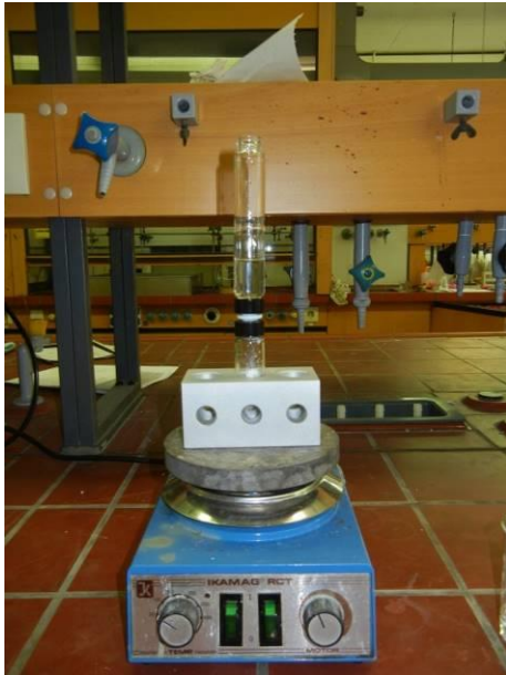
Abb. 2 Versuchsaufbau zum Nachweis von Kohlenstoffdioxid in Sprudelwasser
