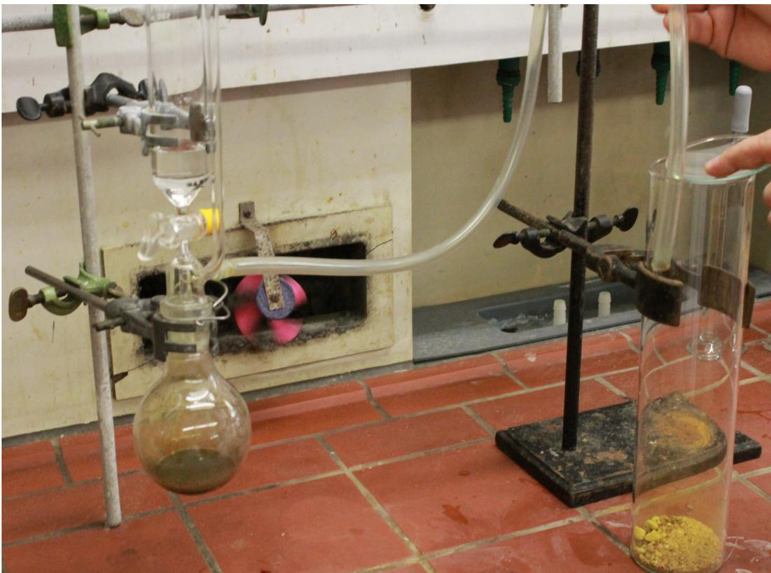
Abbildung 1: Versuchsaufbau zum Erzeugen von Chlorgas.
