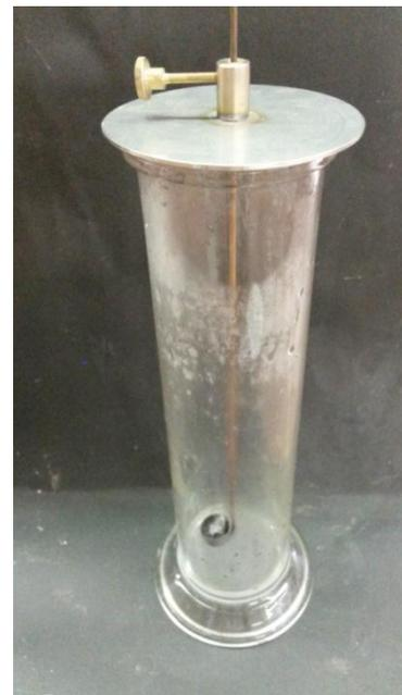
Abb. 2 - Standzylinder mit positiven Kohlenstoffdioxidnachweis
