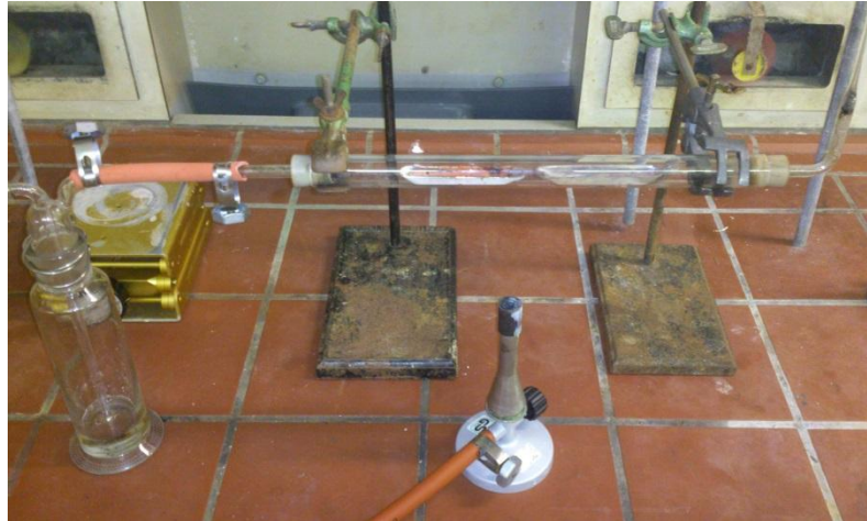
Abb. 1 - Versuchsapparatur zur Bestimmung der Massenverhältnisse von Kupfer und Sauerstoff in den Kupferoxiden (Anmerkung: Am linken Auslassrohr der Waschflasche wird über einen Schlauch die Wasserstoffgasflasche angeschlossen).
