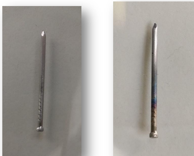
Abbildung 1: Der Eisennagel vor Versuchsbeginn (links) und der Eisennagel nach dem Erhitzen und Abschmirgeln (rechts).
