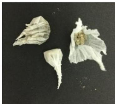
**Abbildung 1: Knallerbse nach Reaktion (links), unbenutzte Knallerbse (mitte), geöffnete, unbenutzte Knallerbse (rechts).**
