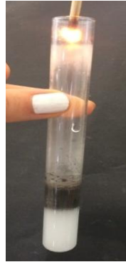
Abbildung 4: Reagenzglas mit Wasserstoffperoxidlösung und Mangandioxid mit positiver Glimmspanprobe.
