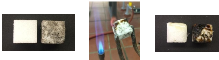
Abbildung 2: unpräparierter und mit Asche präparierter Zuckerwürfel vor dem Anzünden (links); präparierter, brennender Zuckerwürfel (mitte); unpräparierter und präparierter Zuckerwürfel nach dem Anzünden (rechts).
