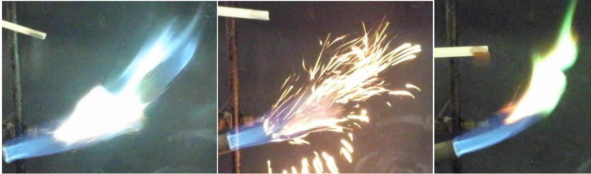
Abb. 5: Zink Verbrennung (links), Eisenverbrennung (Mitte), Kupferverbrennung (rechts)
