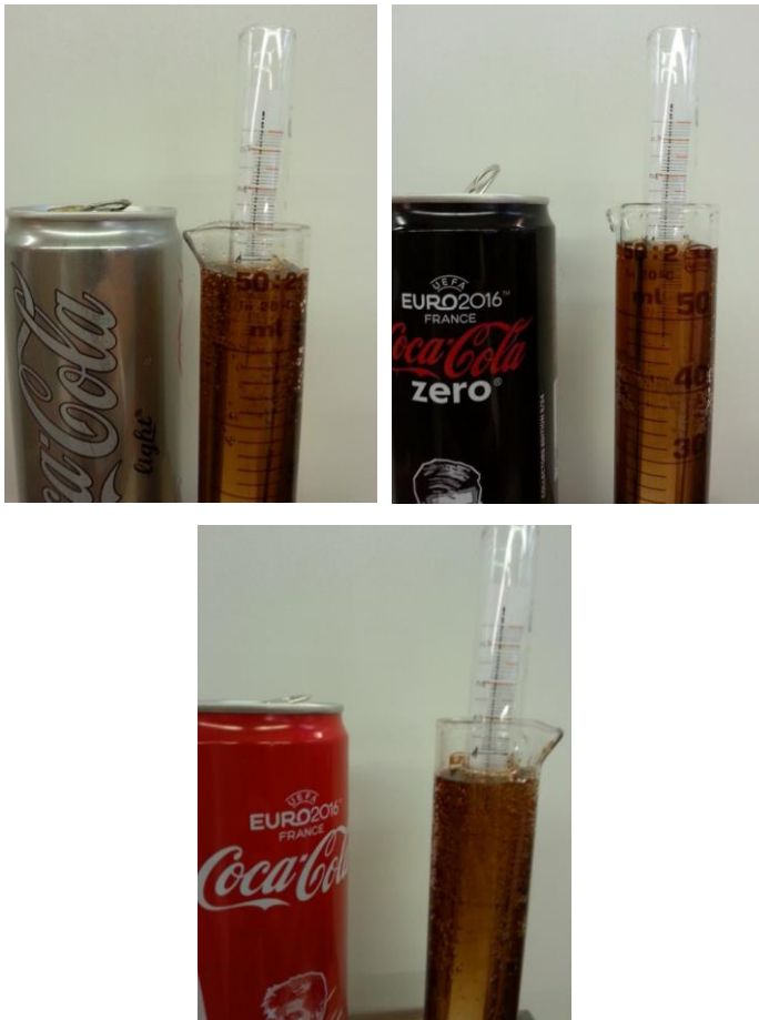
Abb. 3 – Messungen der Dichte von Zuckerlösungen mit Aräometer CocaCola light (oben links), CocaCola Zero (oben rechts) und CocaCola (unten).
