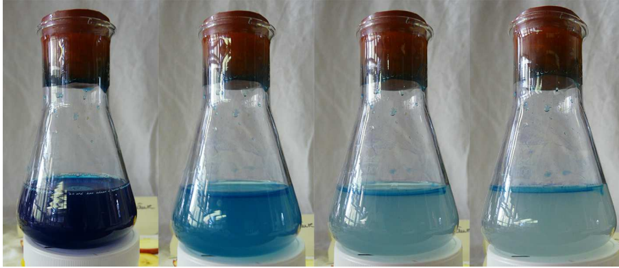
Abb. 4 - Verlauf der Entfärbung in einer „Blue Bottle“
