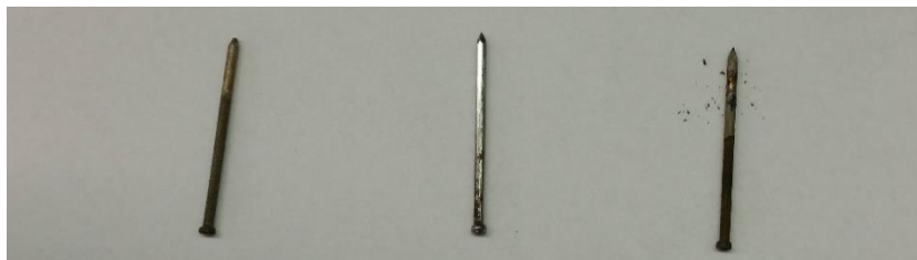
Abbildung 1: Jeweils das untere der Nägel stand in der Säure. Links: Nagel aus der Citronensäure. Rechts: Nagel aus der Phosphorsäure mit dunkler Verfärbung. Mitte: Rostfreier Nagel zum Vergleich.
