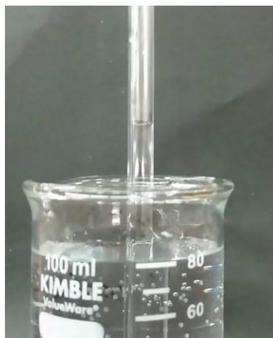
Abbildung 3: Wasser aus dem Becherglas wird durch den durch Sauerstoffverbrauch im Reagenzglas entstehenden Unterdruck im Glasrohr nach oben gezogen.
