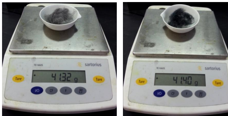
Abbildung 3 - Links: Eisenwolle vor der Verbrennung. Rechts: Eisenwolle nach der Verbrennung.
