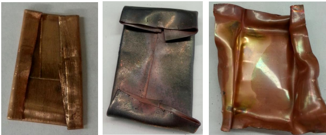
Abbildung 4 – Links: Gefalteter Kupferbrief. Mitte: Erhitzter Kupferbrief. Rechts: Aufgefalteter Kupferbrief.
