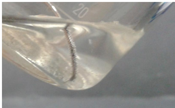
Abb. 5 - Zersetzung des Wasserstoffperoxid am Platindraht.
