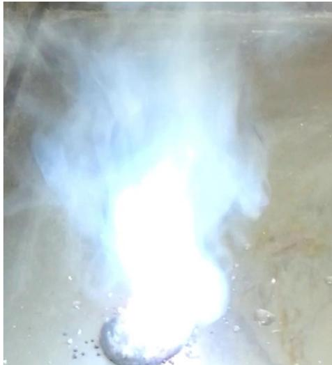
Abbildung 1: Blau gefärbte Flamme der Selbstentzündung von Zink, Ammoniumnitrat und Ammoniumchlorid mit Wasser.
