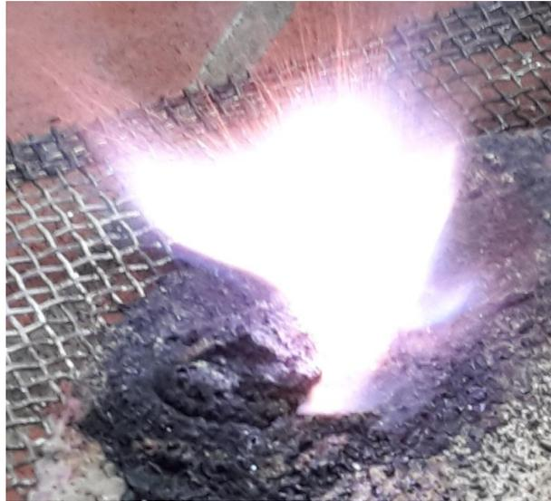
Abbildung 1: Violett gefärbte Flamme der Selbstentzündung von Kaliumpermanganat und Glycerin.
