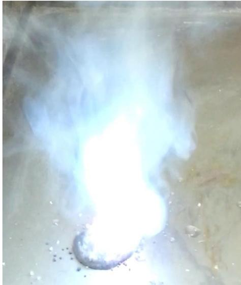
Abbildung 2: Blau gefärbte Flamme der Selbstentzündung von Zink, Ammoniumnitrat und Ammoniumchlorid mit Wasser.
