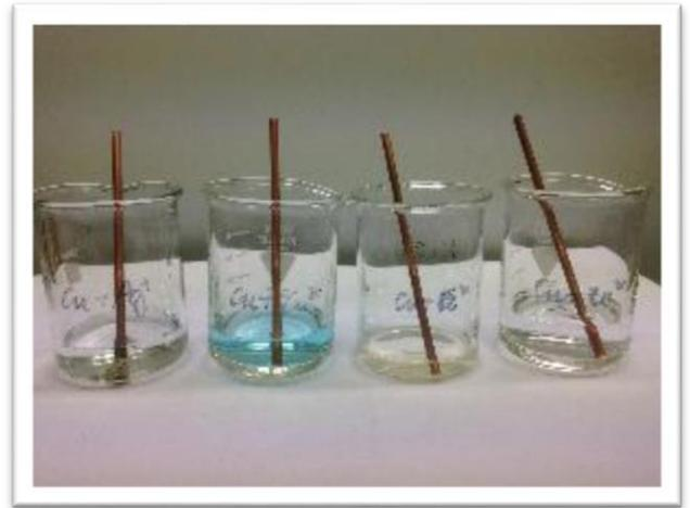
Abb. 6: Kupferbleche in den entsprechenden Lösungen (s.o.).
