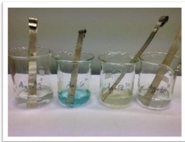
Abb. 5: Silberelektroden in den entsprechenden Lösungen (s.o.).
