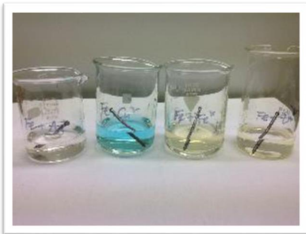
Abb. 7: Eisennägel in den entsprechenden Lösungen (s.o.).
