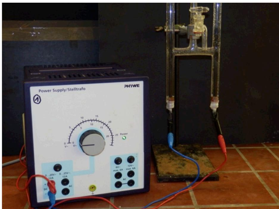
**Abbildung 1:** Aufbau der Hofmannschen Zersetzungsapparatur zur Elektrolyse.
