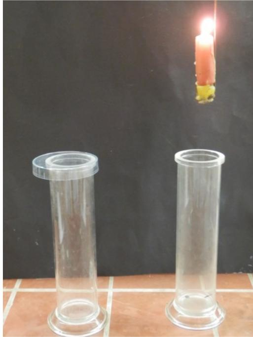
**Abbildung 3:** Eine Kerze wird nacheinander in einen mit Stickstoff (links) und einen mit Luft gefüllten Standzylinder (rechts) gehalten.
