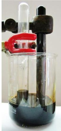
Abb. 1 – Versuchsaufbau zur Sauerstoffgehaltsbestimmung mit alkalischer Pyrogallollösung.
