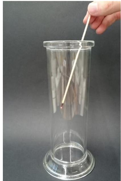
Abbildung 1 - Negative Glimmspanprobe in Standzylinder 2.
