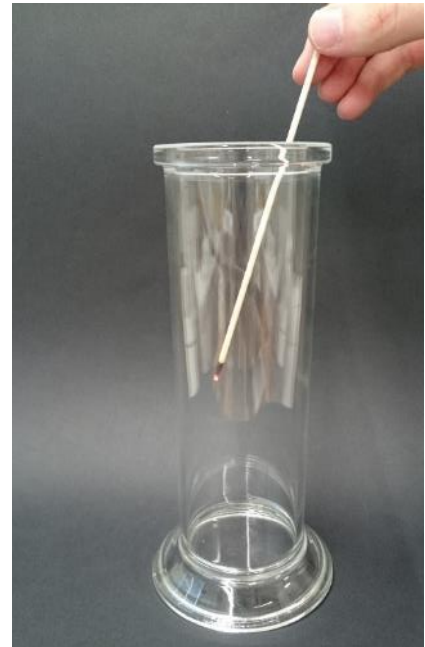
Abbildung 2 - Negative Glimmspanprobe in Standzylinder 2.
