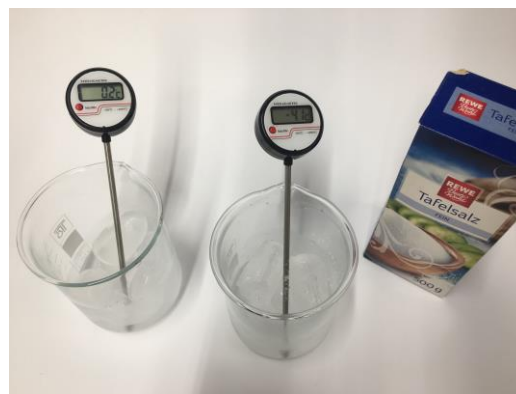
Abbildung 6: Bechergläser mit Eiswasser und Thermometer. Im rechten Becherglas ist zusätzlich Salz enthalten.
