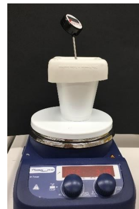
Abbildung 3: Aufbau zum Versuch „Lösen verschiedener Salze“
