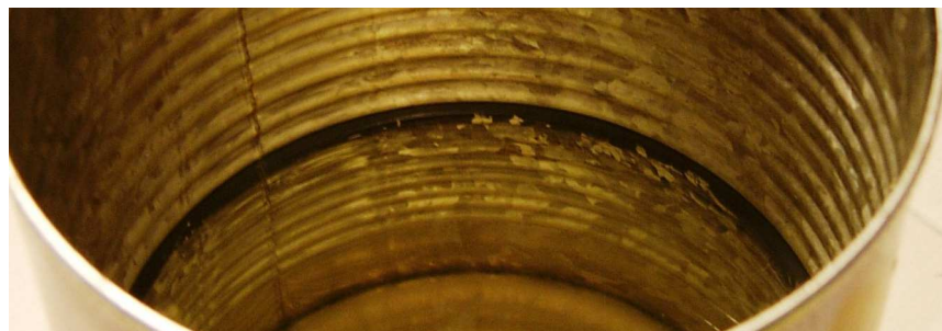
Abbildung 7 verzinnte Dose mit korrodiertem Rand nach 24 Stunden
