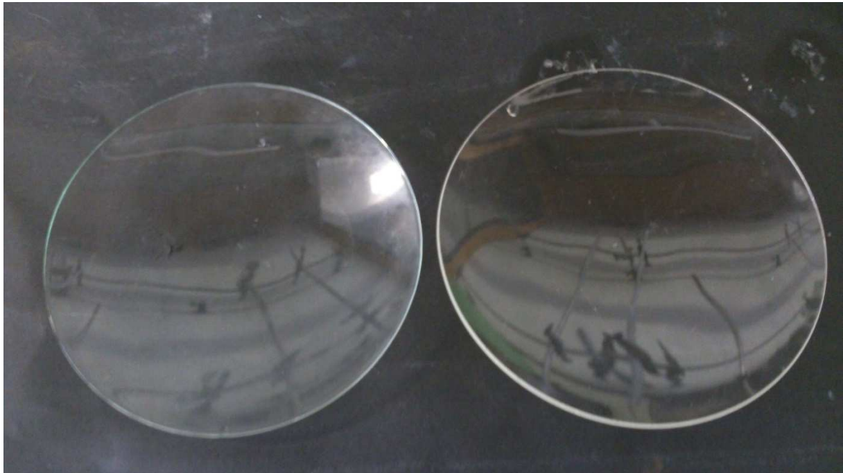
Abb. 11 - Saubere Glasgeräte, nach der Reinigung mit Ascorbinsäure (links) und Essigsäure (rechts)
