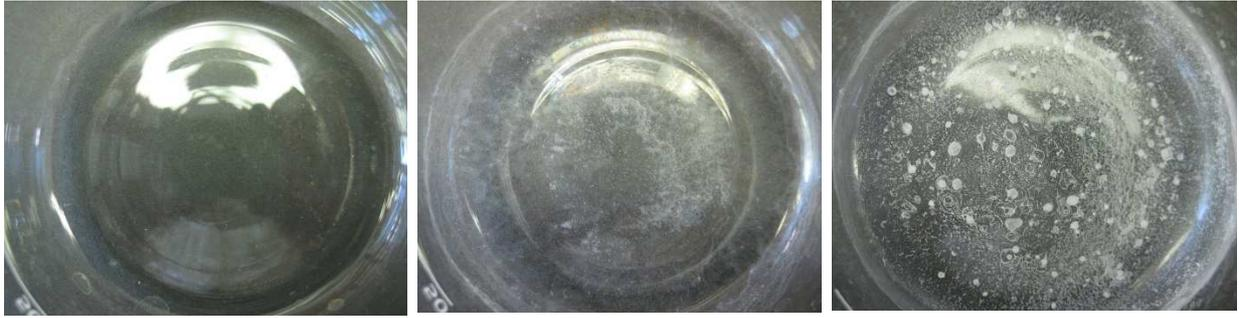
Abbildung 1 - Bechergläser nach dem Verdampfen der Flüssigkeiten, von rechts nach links: demineralisiertes Wasser, Leitungswasser, Mineralwasser
