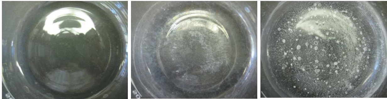
Abbildung 2 - Bechergläser nach dem Verdampfen der Flüssigkeiten, von rechts nach links: demineralisiertes Wasser, Leitungswasser, Mineralwasser
