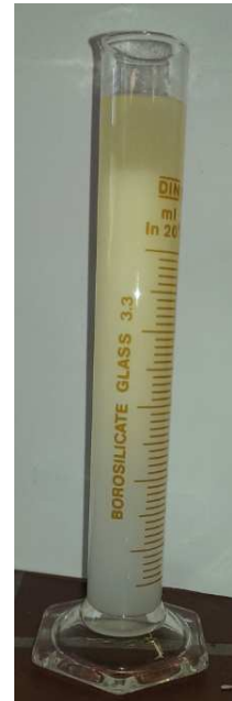
Abb.2 - Trennung des Biodiesels von Methanol und Natriumhydroxid in dest. Wasser
