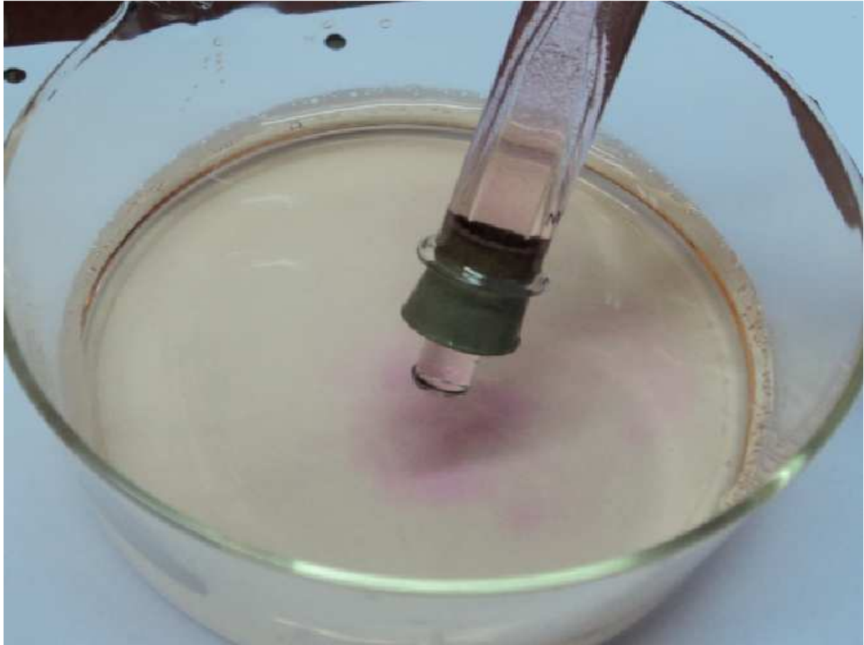
Abbildung 1: Durch den Unterdruck ins Reagenzglas gestiegenes, rot gefärbtes Wasser.
