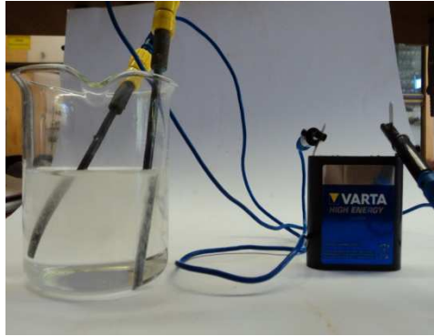
Abb. 1 - Elektrolyse der Kalilauge
