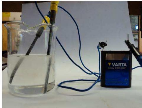
Abb. 1 - Elektrolyse der Kalilauge
