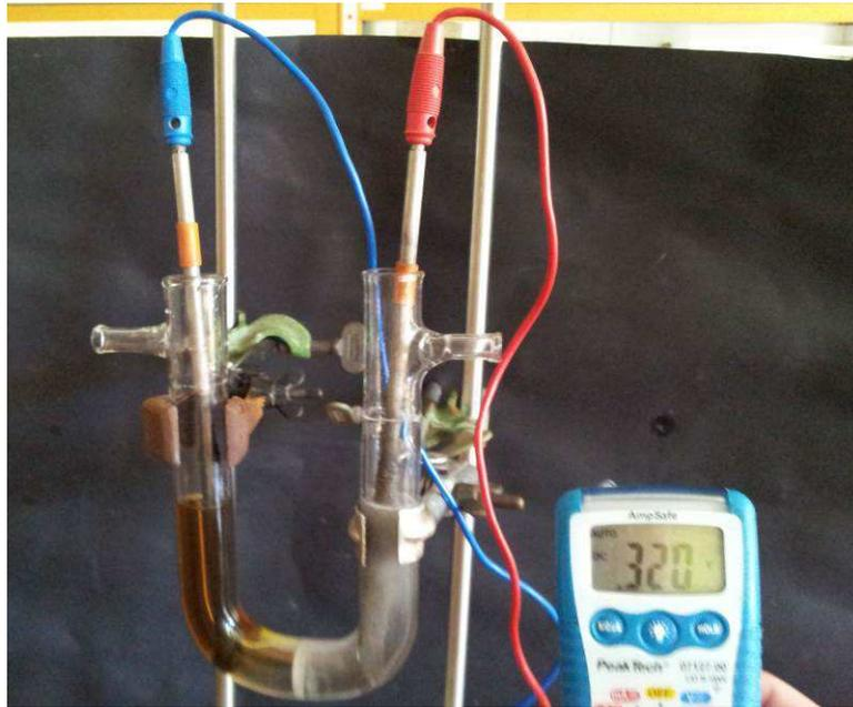
Abb. 2 - Mit Schnaps betriebene Brennstoffzelle
