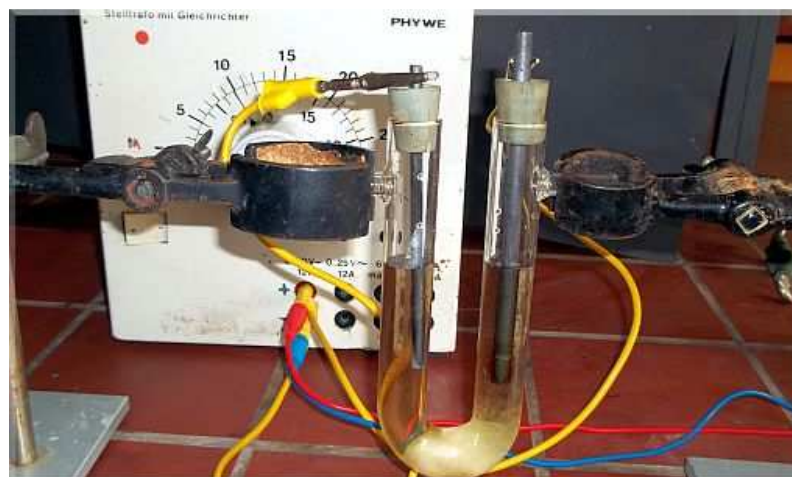
Abb. 6: Versuchsaufbau „Elektrolyse einer Zinkiodidlösung“ links: Kathode; rechts: Anode
