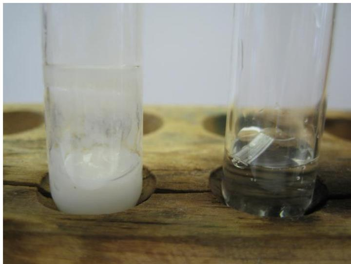
Abb. 5: Reaktion von Wasser mit Calcium (links) und mit Magnesium (rechts).
