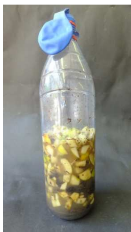
Abb 2: Die Biogasanlage kurz nach dem Befüllen
