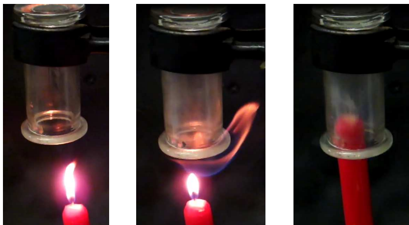
Abb 5: Kerze in und außerhalb des mit Methan gefüllten Standzylinders.
