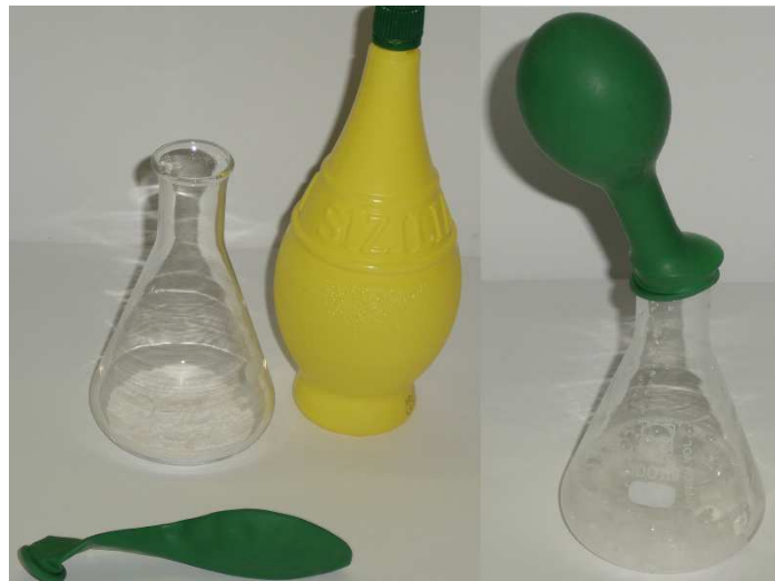
Abb. 5 - Backpulver und Zitronensaft reagieren miteinander unter Gasentwicklung.
