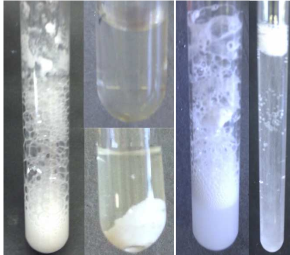
Abb. 7 - linkes Bild: Lösungsvorgang in Zitronensäure-Lsg. (links), Calciumcarbonat vollständig gelöst (rechts oben), ausgefallener Niederschlag (rechts unten).
