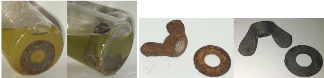
Abb. 8 - Eisenstücke im Zitronensaft (linkes Bild) und Eisenstücke vor und nach der Behandlung mit Zitronensaft (rechtes Bild).
