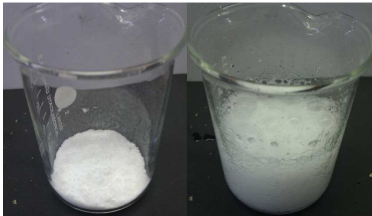
Abb. 4 - Natriumhydrogencarbonat und Citronensäure reagieren unter Gasentwicklung.
