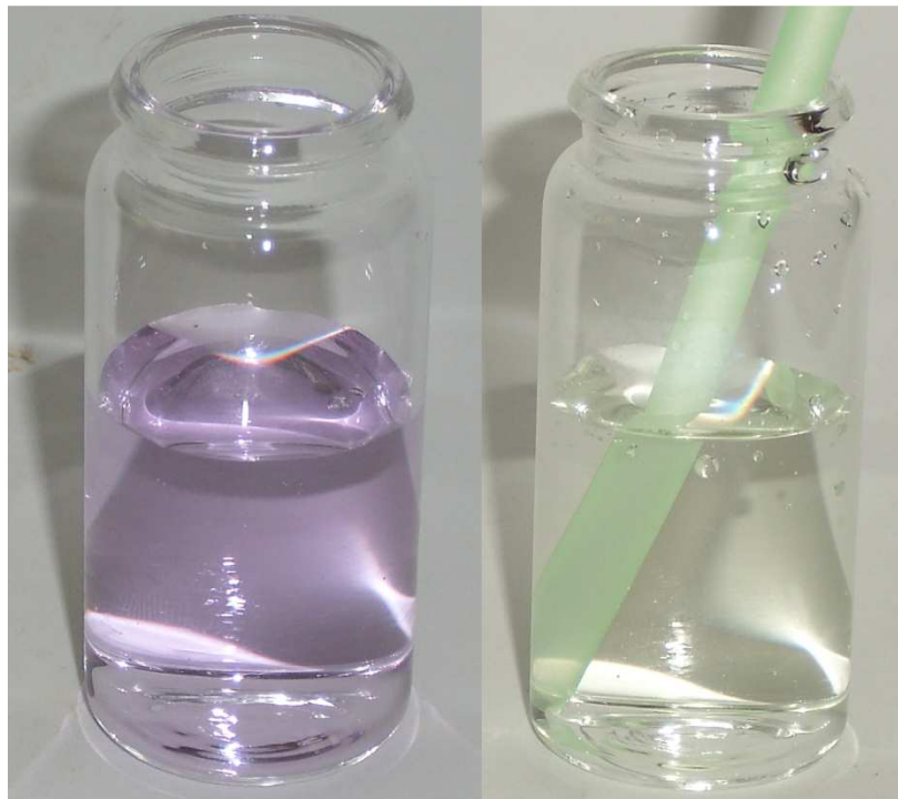
Abb. 2 - alkalische Lösung mit Universalindikator (links) und die selbe Lösung nach dem Hereinpusten (rechts).
