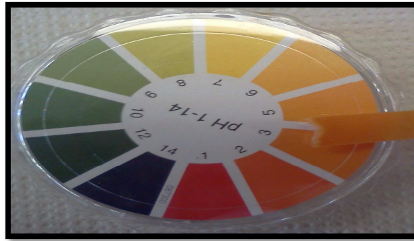
Abb. 2 - Das Indikatorpapier zeigt einen PH-Wert von 3 an.
