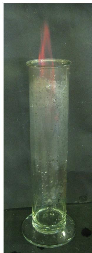
Abbildung 3: Brennendes Ethen im Standzylinder.
