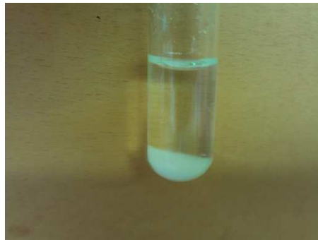
Abbildung 1: entstandener Niederschlag nach der Zugabe von Perchlorsäure
